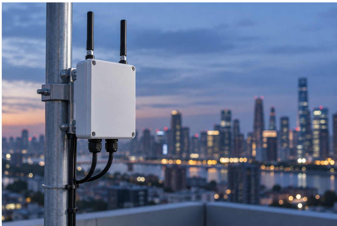
FIGURA 11 Imagen referencial de un nodo terrestre de recepción.
